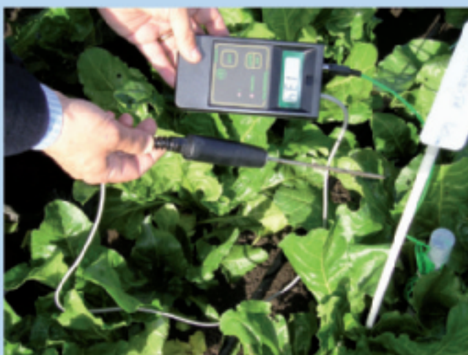
Foto 2. Per la tesi strumentale (TENS) si sono impiegate sonde tensiometriche in grado di misurare l'umidità del terreno.
